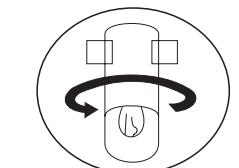
◆ Выверните лампу против часовой стрелки.
