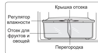
◆ Вы можете отрегулировать влажность в отсеке для фруктов и овощей, повернув ручку регулятора влажности. Поворачивая ручку в разные стороны, можно увеличить или уменьшить влажность.
