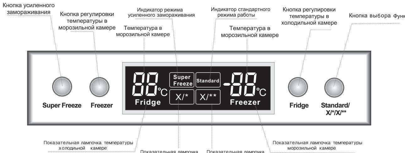
После включения электропитания все лампочки горят и выдерживают 2 секунды, лапочки « Standard » и « Fridge » горят, что значит, холодильник автоматически установлен в стандартном режиме, температура холодильной камеры задана на 5°C, цифровая лампочка показывает температуру верхней камеры – холодильной камеры, вместе с этим звучит музыка включения холодильника.
