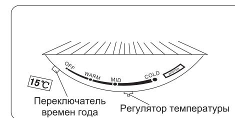
◆ Чтобы отрегулировать температуру во внутренней камере холодильника, поворачивайте ручку регулятора температуры. Отметки "COLD" (Сильное охлаждение), "MID" (Среднее охлаждение) и "WARM" (Слабое охлаждение) обозначают устанавливаемый температурный режим в холодильной камере. Соответственно, чем ближе регулятор к отметке "COLD" (Сильное охлаждение), тем ниже устанавливаемая температура. Если регулятор установлен на отметку "OFF", это означает выключение холодильника.
