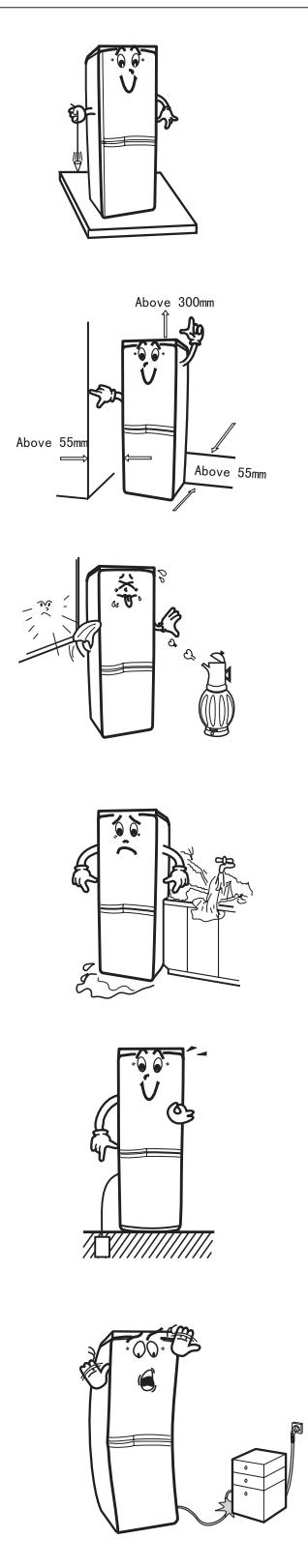
◆ Установите холодильник на твердую, ровную поверхность. Если поверхность недостаточно ровная, выровняйте холодильник с помощью регулировочных ножек, находящихся под корпусом холодильника (чтобы приподнять холодильник, поверните ножку против часовой стрелки). Под регулировочной ножкой находится отверстие, позволяющее регулировать высоту с помощью самых простых инструментов, например, крестообразной отвертки.
