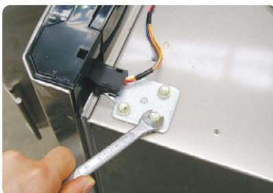
4. Снимите дверцу холодильной камеры, подняв ее вверх. Будьте осторожны, чтобы не уронить дверцу и не поцарапать ее лицевую поверхность.
