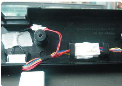
21. Установите на место КРЫШКУ КОРПУСА, убедившись сначала в надлежащем положении жгута проводов.
