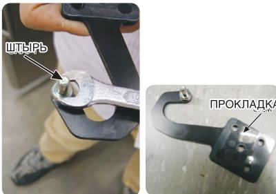
9. После соединения между собой КРЫШКИ ПРОВОДОВ И ПЕТЛИ, ЛЕВОЙ и УЗЛА ВЕРХНЕЙ ПЕТЛИ, а также после изменения положения ВТУЛКИ ПЕТЛИ и КРЫШКИ ЗАЗОРА ДВЕРЦЫ, перенесите УЗЕЛ ВЕРХНЕЙ ПЕТЛИ и установите КРЫШКУ ПРОВОДОВ ДВЕРЦЫ, как показано на рисунке (жгут проводов должен находиться внутри КРЫШКИ ПРОВОДОВ ДВЕРЦЫ).
