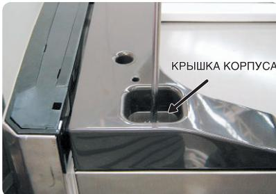
2. Отсоедините жгут проводов внутри КРЫШКИ КОРПУСА.
