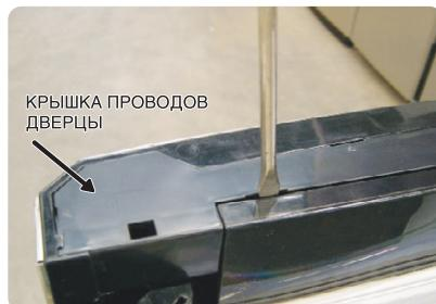
6. Отсоедините КРЫШКУ ПРОВОДОВ И ПЕТЛИ, ПРАВУЮ от УЗЛА ВЕРХНЕЙ ПЕТЛИ, как показано на рисунке. Выньте провод из КРЫШКИ ПРОВОДОВ И ПЕТЛИ, ПРАВОЙ.
