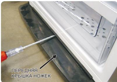
14. Слегка наклонив холодильник назад для удобства работы, демонтируйте УЗЕЛ НИЖНЕЙ ПЕТЛИ, как показано на рисунке, и, перевернув АВТОМАТИЧЕСКУЮ НАПРАВЛЯЮЩУЮ "вверх ногами", поменяйте положение ШТЫРЯ.
