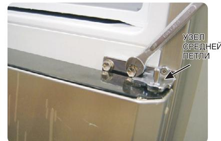
12. Снимите дверцу морозильной камеры, подняв ее вверх. Будьте осторожны, чтобы не уронить дверцу и не поцарапать ее лицевую поверхность.
