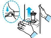
**2** Затем совместите внутреннюю резьбу устройства подачи воды с резьбой на горлышке стандартной бутылки с минеральной водой и наверните устройство на бутылку до упора.
