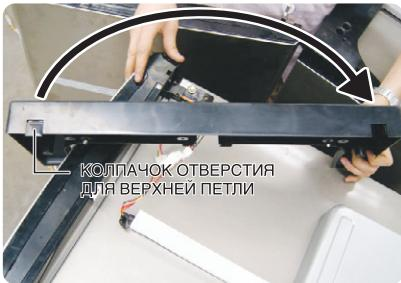
20. Вновь подсоедините жгут проводов и проложите провода внутри КРЫШКИ КОРПУСА, как показано ниже.
