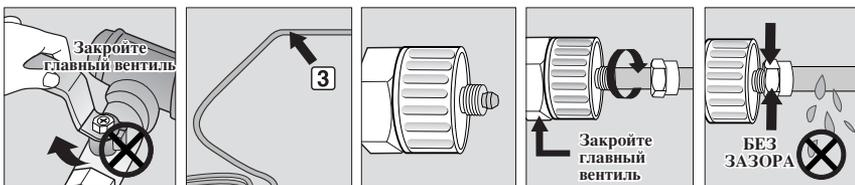
4. После подключения трубопровода для подачи воды к фильтру для воды откройте главный вентиль и, нажимая на рычаг системы подачи воды, вылейте через систему подачи воды примерно 1 литр воды, чтобы прочистить фильтр и заполнить его водой.
