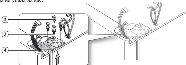
3. Снимите дверцу с нижней петли **5**, для чего осторожно поднимите дверцу **6** прямо вверх.
