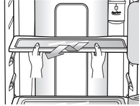
2. Извлеките выдвижной отсек для фруктов и овощей, для чего нажмите на углубления, находящиеся на внутренних левой и правой сторонах крышки отсека для овощей/сухих продуктов и снимите крышку, потянув ее на себя. Держась за отсек одной рукой, слегка приподнимите его вверх, одновременно потянув вперед, и извлеките отсек из холодильника.
