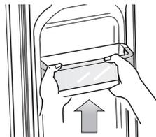
3. Выньте пластиковый выдвижной отсек, потянув его на себя и слегка приподняв вверх.
