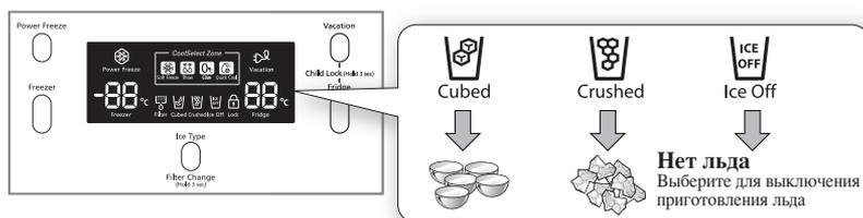
Лед готовится в виде кубиков. При выборе типа льда “Crushed” (Дробленый) устройство приготовления льда измельчает кубики льда в дробленый лед.
