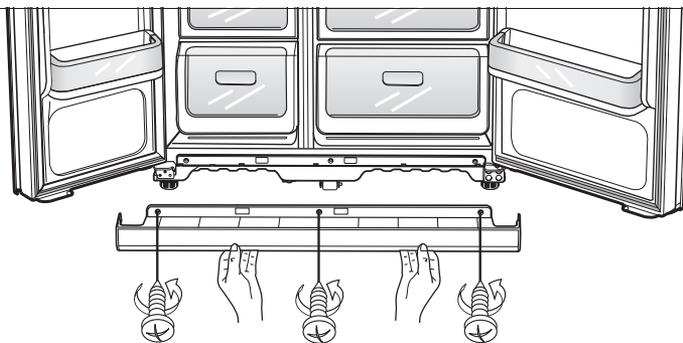
Сначала откройте дверцы морозильной и холодильной камер, а затем снимите крышку, закрывающую ножки, отвернув три винта против часовой стрелки.
