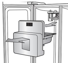
5. Снимите крышку, закрывающую передние ножки, для чего откройте дверцы морозильной и холодильной камер и отверните три винта. Отвернув винты, снимите крышку. Во время последующей сборки установите крышку в первоначальное положение и затяните три винта.
