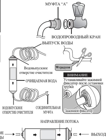
**Примечание:** Срез должен быть круглым, в противном случае возможна протечка воды.
