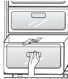
3. Выньте большую дверную нишу, для чего возьмитесь за нее двумя руками и затем снимите, осторожно подняв вверх.
