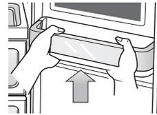
4. Z-образная полка прикреплена к стенке корпуса холодильника. Выньте эту полку для вина, сдвинув ее вверх и осторожно поднимая полку из фиксаторов.
